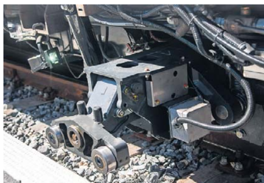
Diese Rollen heben den 26 Tonnen schweren Wagen an und entlasten die Räder, damit die Spurbreite angepasst werden kann.
