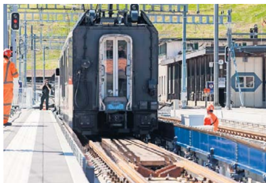
So geht das Umspurieren: Durch die Rinnen im Bildvordergrund wird die Spurbreite an den Wagen verändert.
